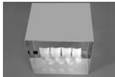
Рис. 2. Фантомы к прибору Lunar Prodigy (version Encore) (Prodigy) (вверху) и QDR «Delphi» модель «Discovery Ci» (Hologic Inc.) (внизу) [7].
